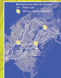
Mapa de la xarxa metropolitana de fibra òptica de la ciutat d'Atenes on es va realitzar el primer experiment de comunicacions òptiques-codificades sobre una portadora caòtica, dintre del marc del projecte Europeu OCCULT coordinat des de l'IFISC.
